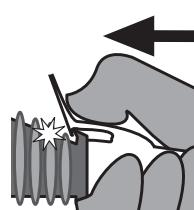
Attacher le loquet du haut en poussant vers l'arrière de l'appareil, jusqu'à ce qu'un "déclic" sonore se fasse entendre.
