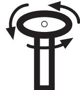
Gire las válvulas del tanque a la IZQUIERDA para abrirlas por completo. Las válvulas del tanque deben estar en posición vertical durante su uso.
