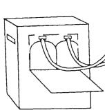
Etirer le tuyau du dispositif d'application.
