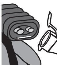
Inserte la lengüeta inferior de la boquilla en la ranura inferior de unidad de dispersión.
