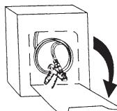
Appuyez en haut du panneau avant pour ouvrir. Abaissez le rabat pour l'installation du tuyau du dispositif d'application. Retirez la buse et lire les instructions.
