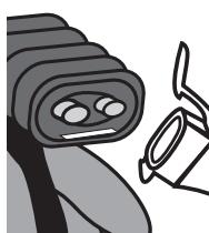
Insérez l'onglet en bas de la buse dans la rainure inférieure du dispositif d'application.
