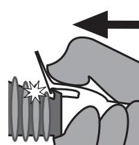
Conecte el sujetador superior empujándolo hacia la parte posterior de la unidad, hasta que se oiga un "sonido de enganche".
