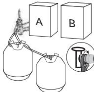
Enrosque la manguera de código rojo al tanque del componente "A" y la manguera de código negro al tanque del componente "B", y apriete con una llave inglesa de 9/16".
