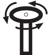
En tournant les robinets DANS LE SENS CONTRAIRE AUX AIGUILLES D'UNE MONTRE, ouvrir les deux robinets complètement. Les robinets des réservoirs doivent être en position verticale pendant l'utilisation.
