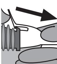
Para quitar la boquilla usada, empuje hacia arriba el sujetador superior y luego hacia adelante para desengancharla.
